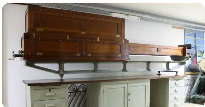
Espectrógrafo Hilger, vista exterior ubicado en el subsuelo del IFLP
