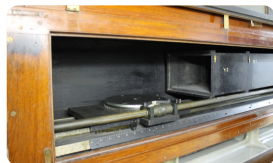
Parte interior del cuerpo más grande del espectrógrafo, donde van ubicados los diferentes montajes.
